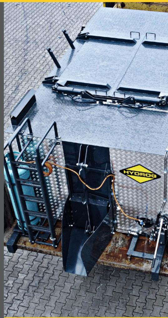
Los termos gravitacionales **HYDROG TR-G** son dispositivos fiables para el transporte y la dosificación de aglomerado asfáltico en caliente, que facilitan considerablemente la reparación de pavimentos. Gracias a su diseño moderno y a un sistema de calefacción eficiente, mantienen la mezcla a la temperatura adecuada durante horas, lo que se traduce en una mayor calidad y durabilidad de las reparaciones.
