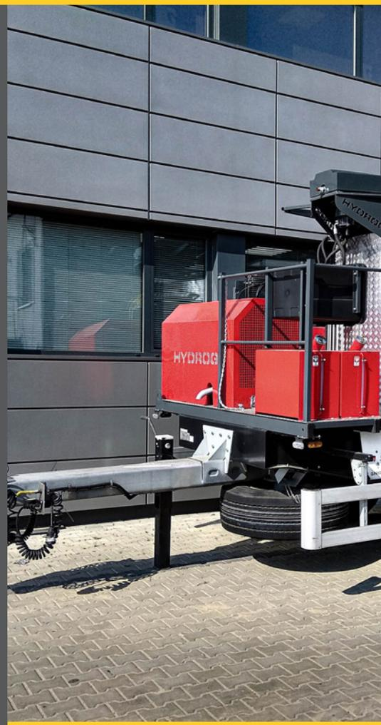
Las calderas **HYDROG KA-4400** son equipos modernos y eficientes que garantizan la preparación y transporte precisos del asfalto fundido sin pérdida de sus propiedades. Ideales para la construcción y renovación de superficies en puentes, pasos elevados, aparcamientos, vías de tranvía o carriles bici. Garantizan ahorro de tiempo, material y costes laborales.
