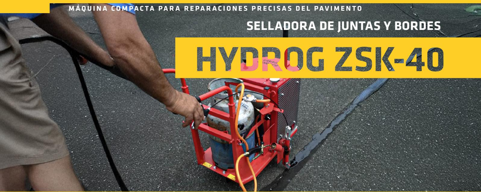
La **HYDROG ZSK-40** es una selladora de juntas y bordes móvil y fácil de usar, ideal para reparaciones rápidas y eficaces de superficies viales. Gracias a su tamaño compacto y su diseño sencillo, puede ser operada por una sola persona, lo que minimiza los costos laborales y aumenta la eficiencia del trabajo.
