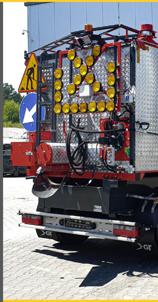
Los termos **HYDROG TR-H** son dispositivos especializados para el transporte, calentamiento y dosificación de aglomerado asfáltico en caliente y emulsión bituminosa, que garantizan reparaciones rápidas y duraderas del pavimento. Gracias a sus funciones integradas, permiten realizar una reparación completa en un solo proceso, sin necesidad de máquinas adicionales.
