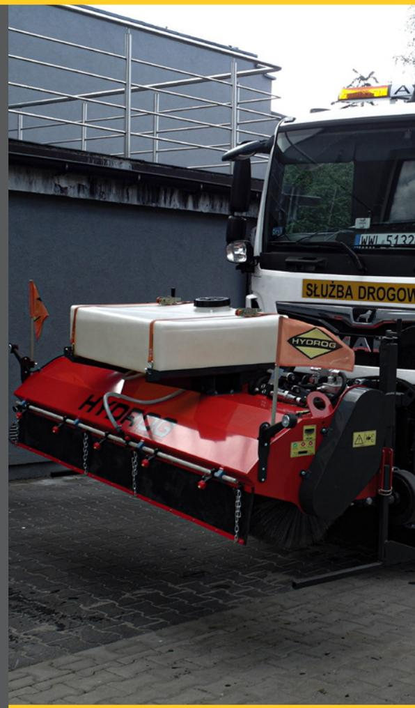
A veces, las soluciones simples son las mejores. Las rociadoras de emulsión **HYDROG SR KOMPAKT** son un modelo creado para usuarios que buscan el equilibrio ideal entre precisión de rociado y precio accesible. Su diseño simplificado, con barra de rociado desplegable manualmente y boquillas con sistema de doble cobertura, garantiza una alta calidad de aplicación al mismo tiempo que reduce los costes de adquisición y operación.
