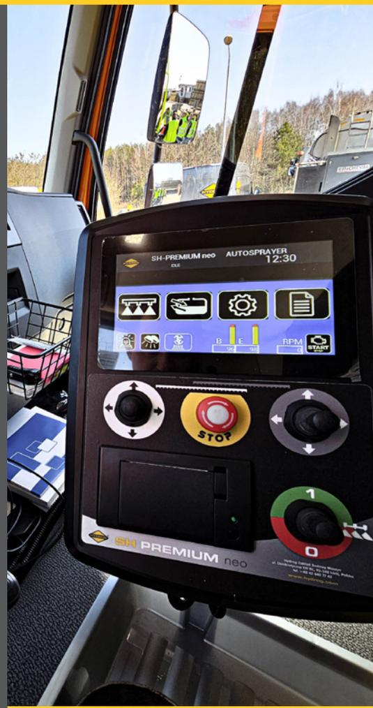
Las rociadoras de emulsión **HYDROG SH PREMIUM** son los modelos más avanzados de la marca, que combinan automatización industrial de última generación con una precisión excepcional de rociado. La aplicación ultraprecisa de emulsión bituminosa, junto con la posibilidad de generar informes de cada rociado individual y resúmenes periódicos, permite un control total de la calidad del trabajo y la documentación completa del proyecto.
