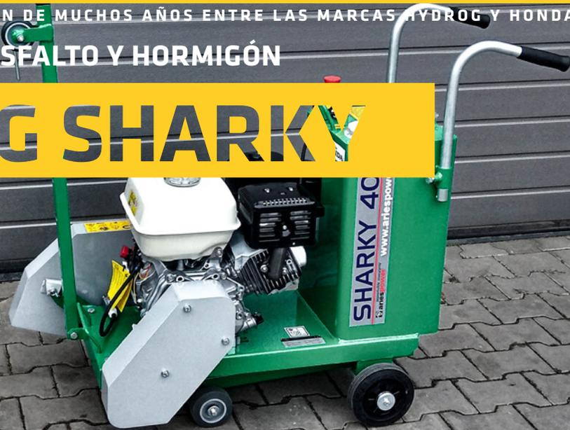
Las cortadoras viales **HYDROG SHARKY** son máquinas profesionales diseñadas para el corte preciso de asfalto y hormigón – ideales para realizar juntas de dilatación, reparaciones de pavimentos y otros trabajos especializados.
