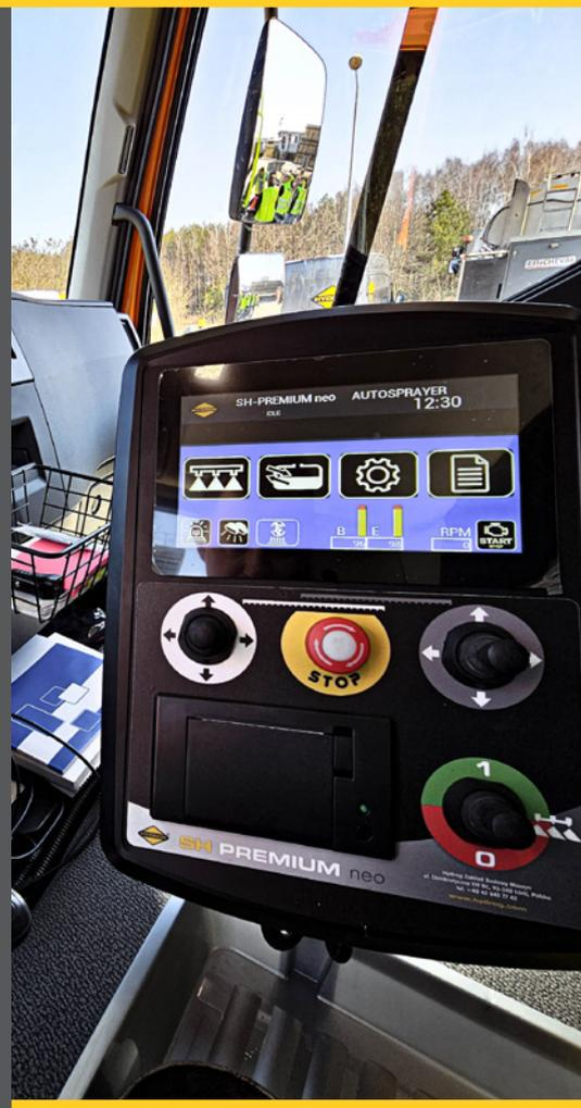
Les arroseuses d'émulsion **HYDROG SH PREMIUM** représentent les modèles les plus avancés de la marque, alliant automatisation industrielle de pointe et précision exceptionnelle de pulvérisation. Leur système de pulvérisation ultra-précis de l'émulsion bitumineuse, combiné à la génération de rapports pour chaque opération ou sur une période donnée, permet un contrôle total de la qualité des travaux et une documentation complète de leur exécution.
