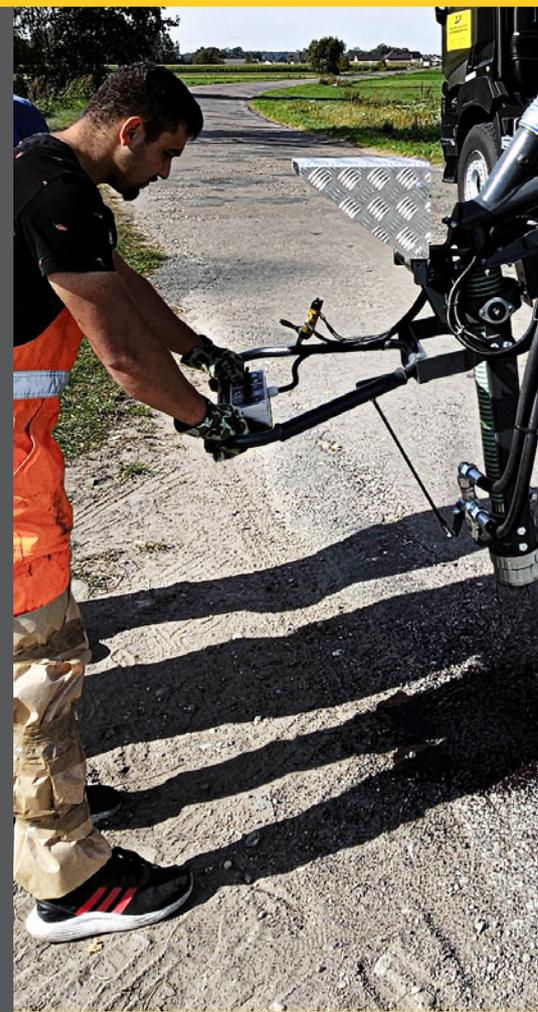
Le réparateur **HYDROG PA-5000 / PA-6000** est un équipement moderne pour une réparation efficace et économique des revêtements bitumineux. Grâce à la technologie de projection, il remplit et scelle les nids-de-poule avec du gravier minéral enrobé d'émulsion bitumineuse, garantissant la durabilité et la résistance de la surface réparée.
