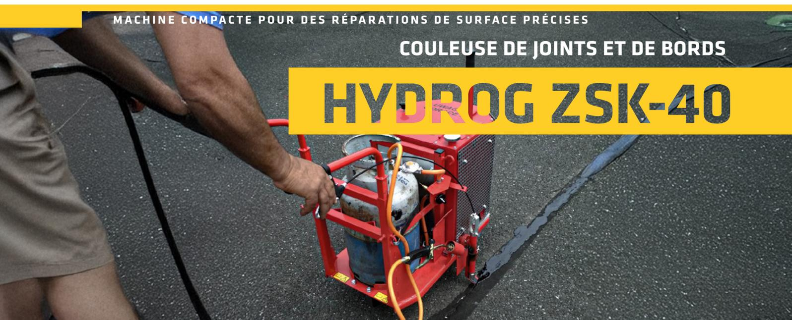
La **HYDROG ZSK-40** est une couleuse de joints et de bords mobile et facile à utiliser, idéale pour des réparations rapides et efficaces des surfaces routières. Grâce à sa petite taille et à sa conception simple, elle peut être utilisée par un seul opérateur, ce qui réduit les coûts de main-d'œuvre et augmente l'efficacité des interventions.
