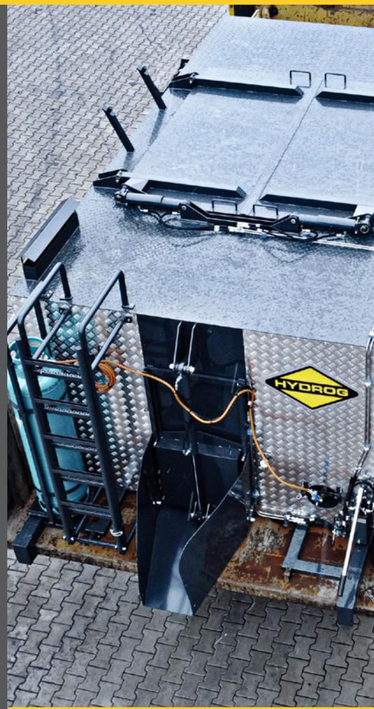
Les thermos gravitaires **HYDROG TR-G** sont des équipements fiables pour le transport et le dosage de l'enrobé bitumineux chaud, facilitant considérablement les travaux de réparation des chaussées. Grâce à leur conception moderne et à un système de chauffage performant, ils maintiennent efficacement la température du mélange pendant de longues heures, ce qui améliore la qualité et la durabilité des réparations.
