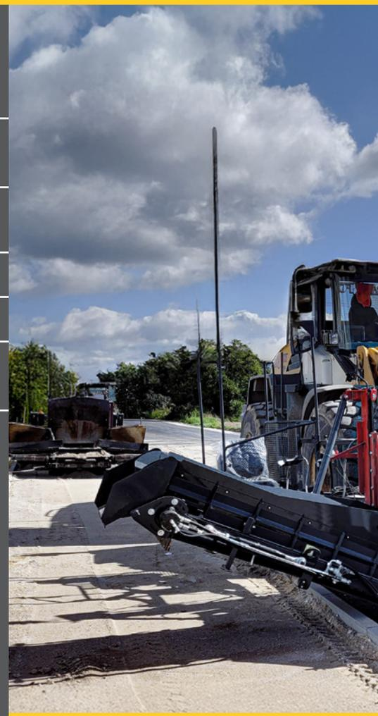
La finitionneuse de bas-côtés **HYDROG DG-3000 PREMIUM** est une solution fiable pour la pose efficace des accotements et des élargissements de chaussée. Grâce à sa capacité à travailler aussi bien avec des granulats routiers qu'avec de l'enrobé bitumineux chaud, cette machine s'adapte parfaitement à divers projets routiers, garantissant précision et durabilité.
