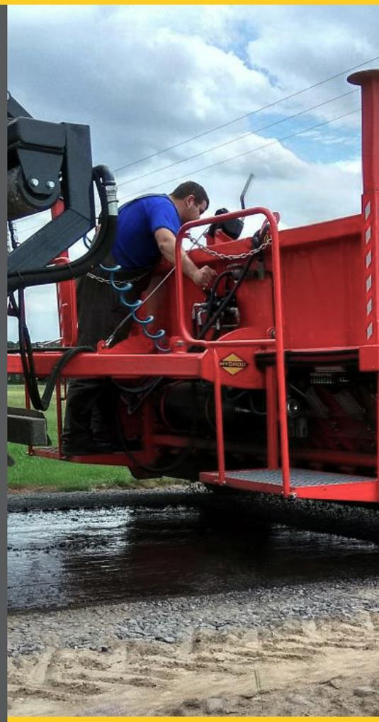
L'épandeur de gravillons **HYDROG RPU-3000 / RPU-3500** est un équipement fiable pour le traitement superficiel des chaussées. Associé à une arroseuse d'émulsion bitumineuse, il constitue un ensemble complet pour des réparations de surface durables et économiques. Grâce à l'alimentation continue en gravillons depuis la benne du camion, le travail s'effectue sans interruptions fréquentes, augmentant considérablement l'efficacité.
