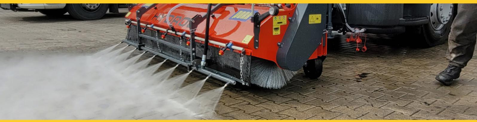
La Hydrog Prowasher 2500 est une laveuse haute pression professionnelle conçue pour le nettoyage efficace des chaussées à l'eau sous haute pression. Équipée d'une rampe de pulvérisation frontale à angle réglable, elle permet d'adapter précisément le jet d'eau aux conditions de la route.
