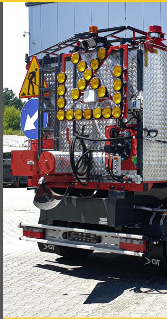
Les thermos **HYDROG TR-H** sont des équipements spécialisés pour le transport, le chauffage et le dosage de l'enrobé bitumineux chaud ainsi que de l'émulsion bitumineuse. Ils permettent des réparations routières rapides et durables. Grâce à leurs fonctions intégrées, ils permettent d'effectuer une réparation complète en un seul processus, sans avoir recours à d'autres machines.
