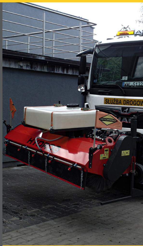
Parfois, les solutions les plus simples sont les meilleures. Les arroseuses d'émulsion **HYDROG SR KOMPAKT** sont conçues pour les utilisateurs recherchant un équilibre idéal entre précision de pulvérisation et prix abordable. Leur construction simplifiée, avec une rampe de pulvérisation déployée manuellement et des buses à double recouvrement, garantit une qualité élevée d'application tout en réduisant les coûts d'achat et d'exploitation.
