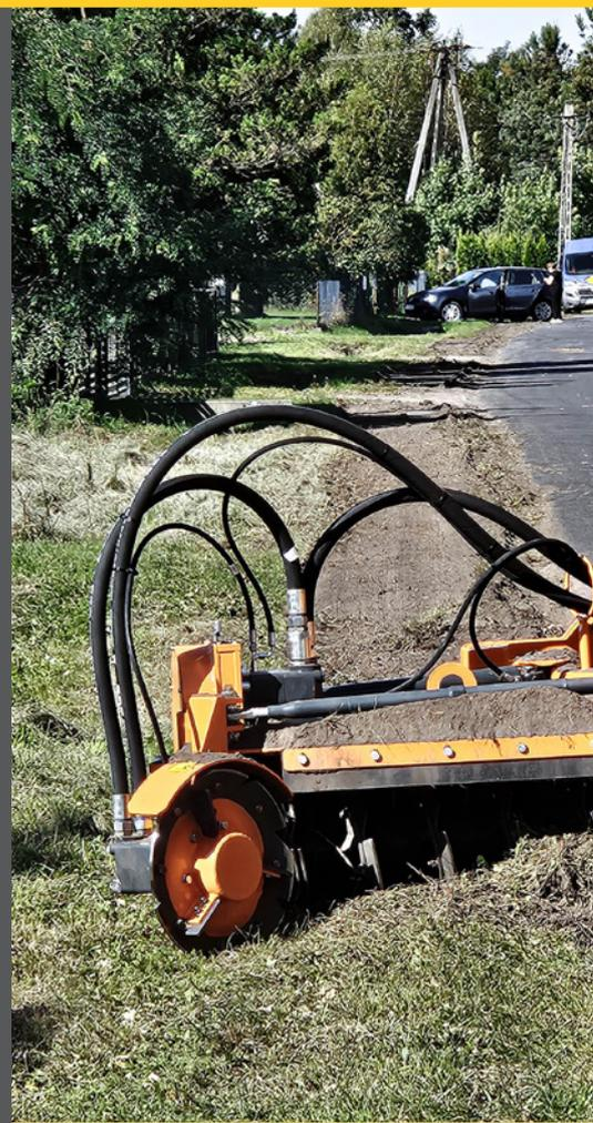
La raboteuse de bas-côtés **HYDROG SP-1200** permet un fraisage et un profilage précis des accotements, assurant un écoulement optimal de l'eau de la surface routière. Cette action empêche l'eau de geler en hiver, protégeant ainsi la route contre la dégradation et prolongeant sa durabilité – ce qui représente des économies concrètes sur les coûts de réparation et de modernisation.
