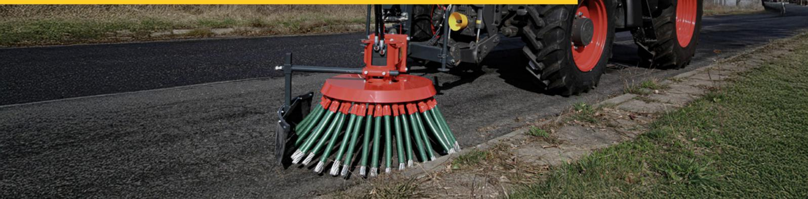
La **HYDROG SCZ-900** est une brosse professionnelle conçue pour l'élimination mécanique des mauvaises herbes et des saletés sur les surfaces pavées, les trottoirs, les plaques alvéolaires et autres revêtements durcis. Grâce à ses brosses puissantes et performantes, elle élimine efficacement les végétaux envahissants sans produits chimiques, ce qui en fait une solution écologique et sûre pour les villes et les services de propreté.
